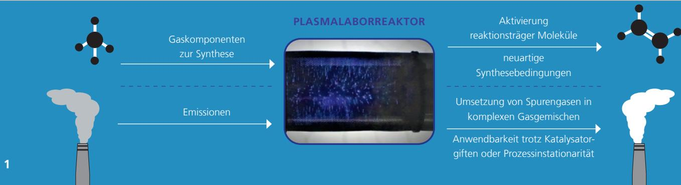
1 Darstellung möglicher Konversionsrouten durch Gasaktivierung mit nicht-thermischem Plasma – exemplarisch dargestellt durch einen Plasmalaborreaktor des Fraunhofer UMSICHT.
